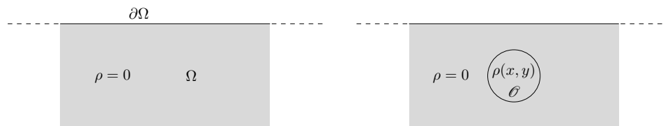
FIGURE 10 – Guide d'ondes de référence / Guide d'ondes perturbé.
