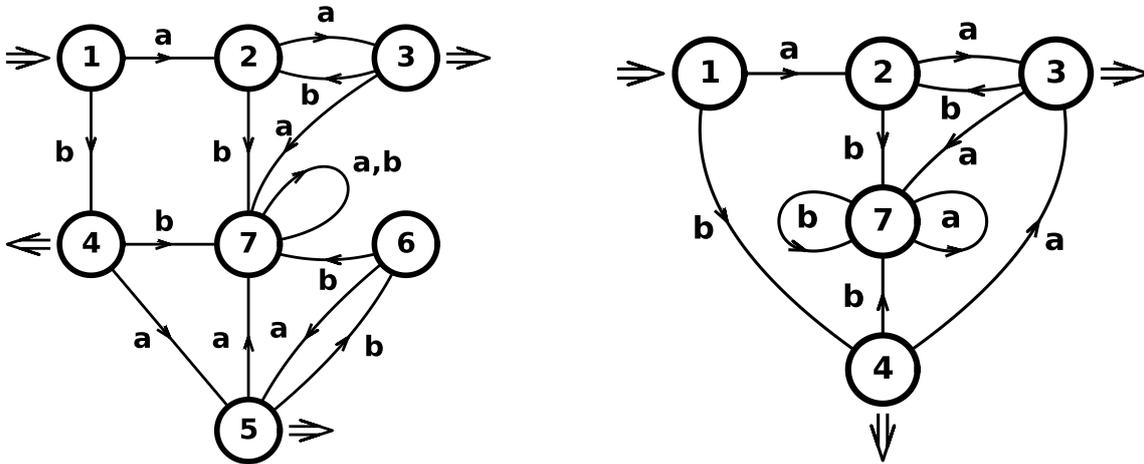
On se rend compte facilement que les mots de petite longueur du langage de l'automate de la figure de gauche sont identiques à ceux de l'automate de la figure de droite :  $b, ba, aa, aaba, etc.$
