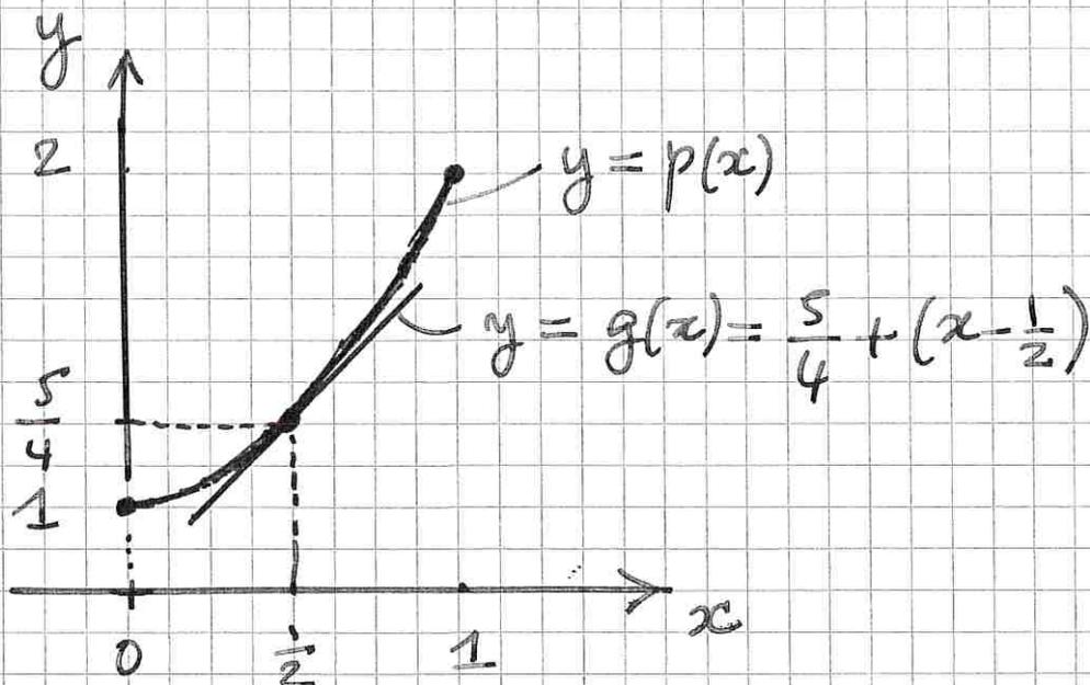
Figure 4. Approximation au voisinage de  $x_0 = 1/2$  de la fonction  $p(p(x) = 1 + x^2)$  par la fonction affine  $g$  avec  $g(x) = \frac{5}{4} + (x - \frac{1}{2})$ .
