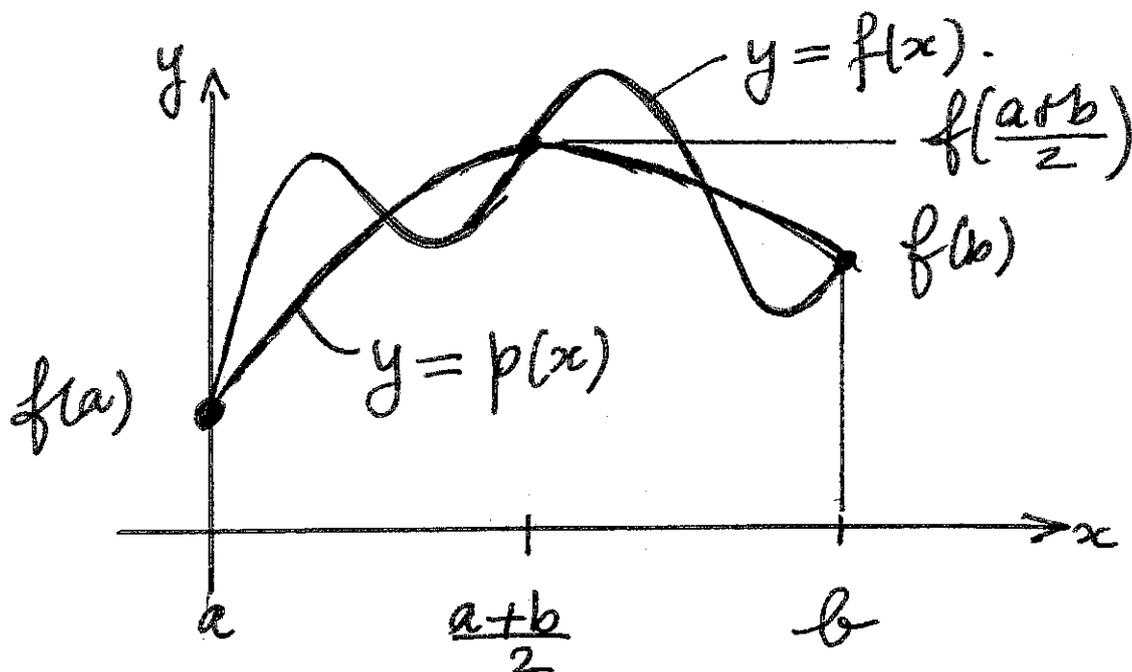
Figure 4. Interpolation parabolique de la fonction  $f$  sur l'intervalle  $[a, b]$ . on la remplace par une fonction polynomiale de degré deux.
