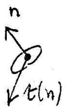
définition de  $\vec{t}$  = force exercée par le fluide sur une plaquette de normale  $n$  (pointant vers le fluide).
