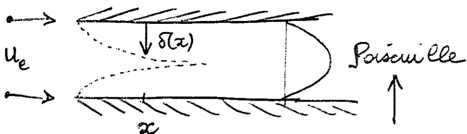
Solution exacte des équations de Navier-Stokes: profil parabolique de vitesse
