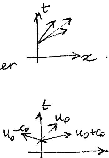
Ainsi des conditions telles que les variables caractéristiques  $\varphi_2$  et  $\varphi_3$  sont calculées à l'aide des données aux limites et la variable caractéristique  $\varphi_1$  est calculée à partir des valeurs dans le champ fluide.
