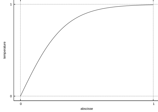
FIG. 1: Profil typique de couche limite thermique.
