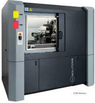
Tomographe à rayon X (Laboratoire Matéis)
