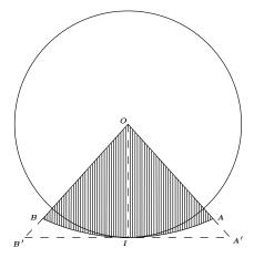
L'idée est la suivante : plutôt que d'approximer l'aire d'un disque de rayon 1 par l'aire de  $4.2^n$  triangles OA'B', il est préférable de l'approximer par  $4.2^n$  morceaux de secteurs à base parabolique OAB. Il existe en effet une unique parabole qui passe par les trois points A, I, B et qui est tangente au cercle à l'ordre 2 au point I.
