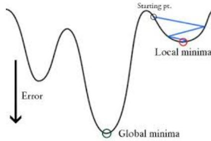
Figure 2.1 – Illustration de la convergence locale des descentes de gradient dans le cas d'une fonctionnelle non convexe.
