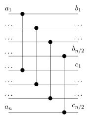
Montrer que les deux listes de sortie  $b_1, \dots b_{n/2}$  et  $c_1, \dots c_{n/2}$  sont bitoniques, et que tout  $b_i$  est inférieur ou égal à tout  $c_j$ .
