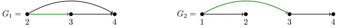
FIGURE 3.3 – L(G_1) = 2 et L(G_2) = 2 pour les graphes de la figure 3.2. Les plus long chemins sont en vert.
